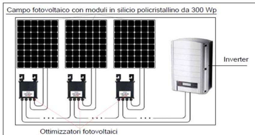
Fig. 1 - Particolare collegamento ottimizzatori solari
