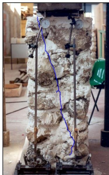
3.8 Quadro fessurativo a rottura del campione 1
